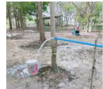
สูบทดสอบบ่อ BH-04 และวัดระดับน้ำบ่อสังเกตการณ์ BH-03 ครั้งที่ 1 วันที่ 8 มกราคม 2566
