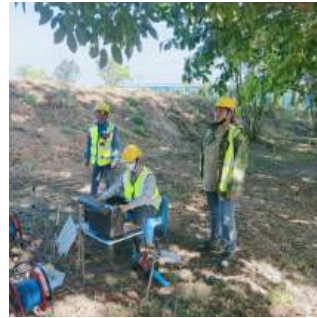
การสำรวจธรณีฟิสิกส์บนผิวดินแบบภาคตัดขวางแบบ 2 มิติ บริเวณ waste area
