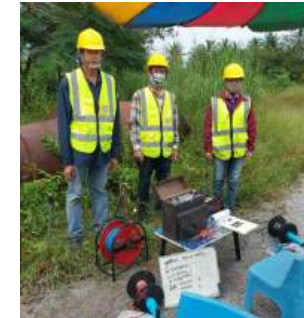
การสำรวจธรณีฟิสิกส์ด้วยวิธีวัดค่าความต้านทานไฟฟ้าในแนวตั้ง บริเวณ waste area
