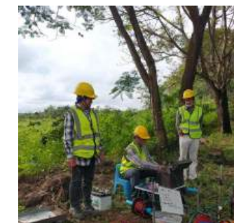
การสำรวจธรณีฟิสิกส์ด้วยวิธีวัดค่าความต้านทานไฟฟ้าในแนวตั้ง บริเวณด้านตาง
