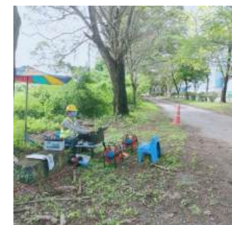
การสำรวจธรณีฟิสิกส์ด้วยวิธีวัดค่าความต้านทานไฟฟ้าในแนวตั้ง บริเวณด้านตาง
