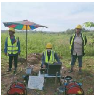
การสำรวจธรณีฟิสิกส์บนผิวดินแบบภาคตัดขวางแบบ 2 มิติ บริเวณด้านตาซัง
