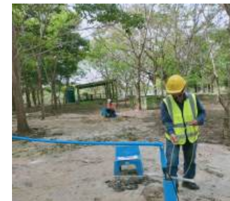
สูบทดสอบบ่อ BH-04 และวัดระดับน้ำบ่อสังเกตการณ์ BH-03 ครั้งที่ 1 วันที่ 8 มกราคม 2566
